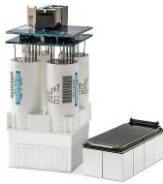
[그림 1-3] (좌) 기존 PET-CT에서 사용되던 아날로그 PM Tube (우) 새로 도입되는 Digital PET-CT의 SiPM 방식의 Detector
