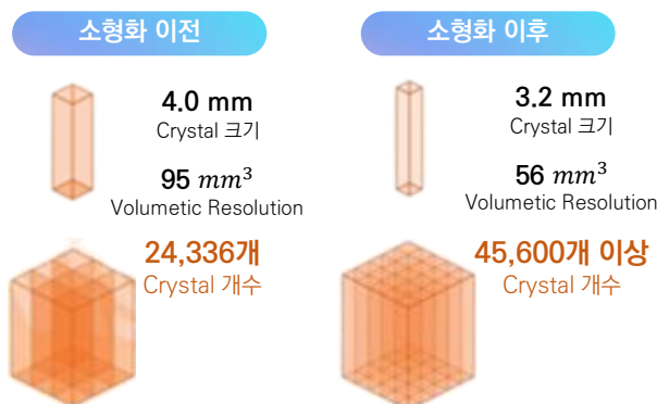
[그림 1-4] 아날로그 방식의 디텍터와 디지털 방식의 디텍터의 Crystal 개수
